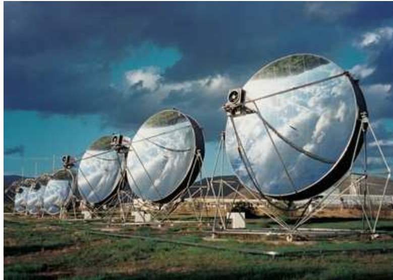
Fig. 1.25 – Sistema Dish-Stirling (diametro 10 m 2 , potenza elettrica generata 25 kW) [15].
