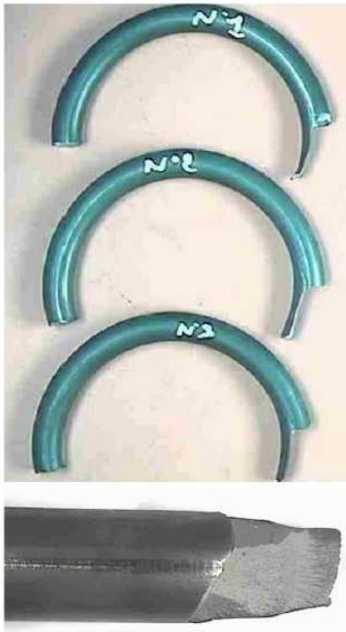
**Fig.4 Esempi di rottura della spira durante il processo di formatura**
