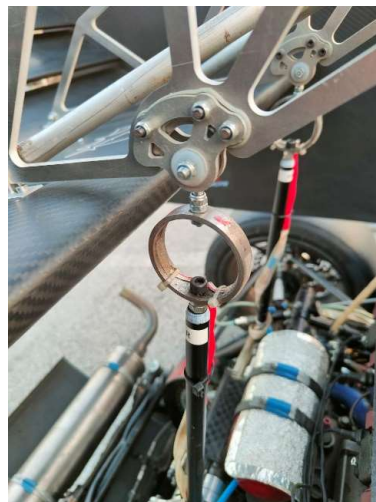
Setup Sperimentale - SX: Ala Anteriore – DX: Ala Posteriore
