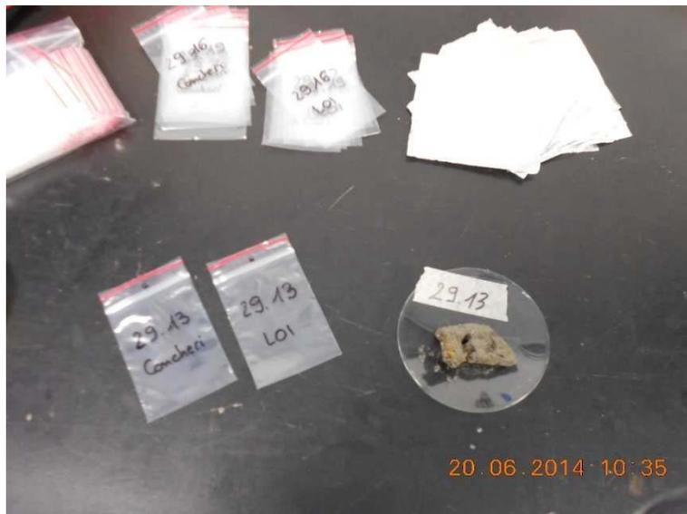
Figura 6. Campione estratto dal forno e pronto per la pesatura. Accanto sono posizionate le buste, già contrassegnate, per conservare il campione destinato ad alcune analisi.
