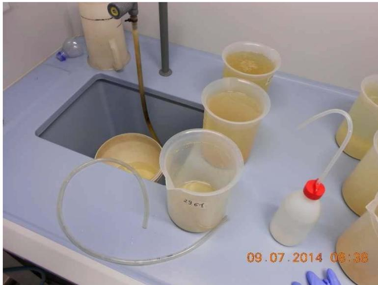
Figura 11. Secchio e becher nella geometria sopra discussa. A fianco il tubicino di gomma per il sifonamento e acqua deionizzata all'interno dell'apposito contenitore.
