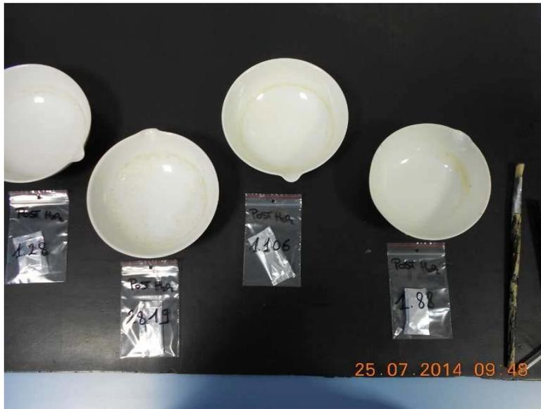
Figura 15. Capsule già trattate e sedimento all'interno delle rispettive buste ermetiche.
