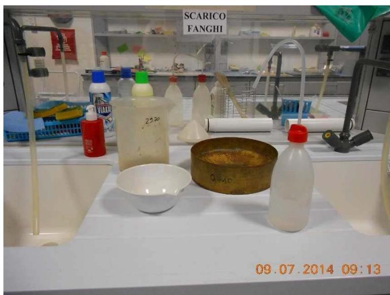
Figura 12. Capsula, becher e setaccio prima dell'operazione, liquido e sedimento sono nel becher.
