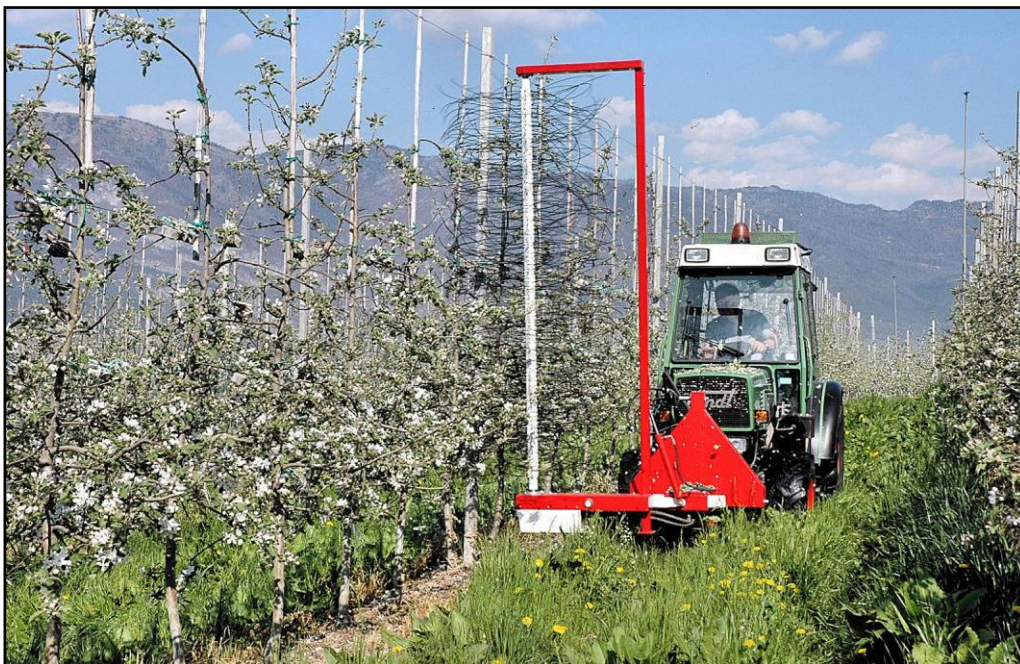
Figura 1 - Diradamento meccanico tramite macchina Darwin in funzione a 10 km/h su Red Delicious spur in Val di Non (Foto A. Dorigoni).
