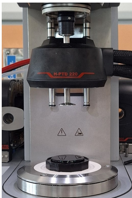
Figura 36: posizionamento del gel siliconico sul piatto inferiore del reometro
