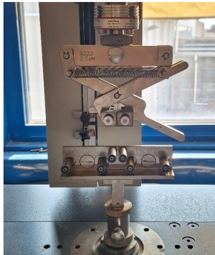
Figura 33: tool per l'esecuzione del peel test a 90°
