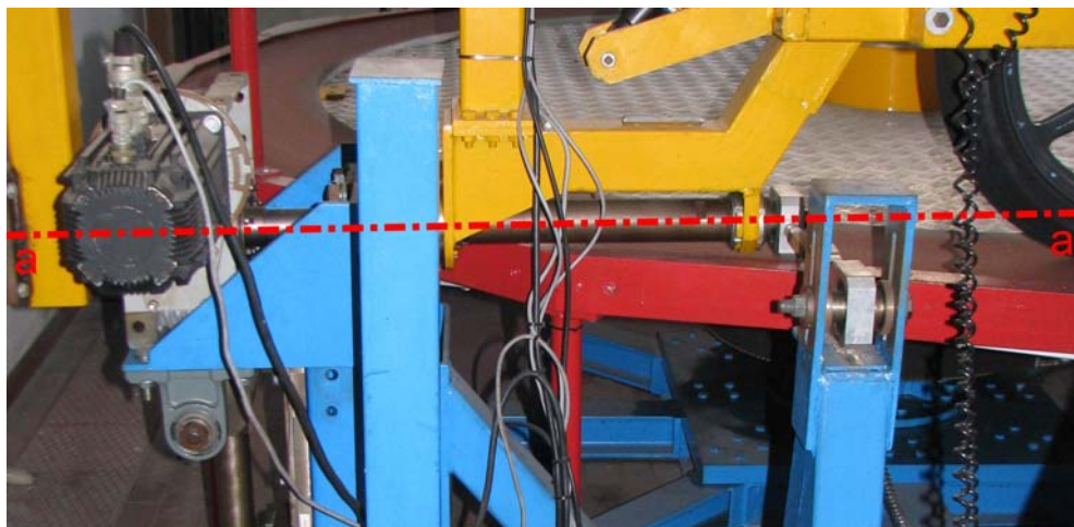
Figura 1.12: Asse di rollio del braccio porta ruota
