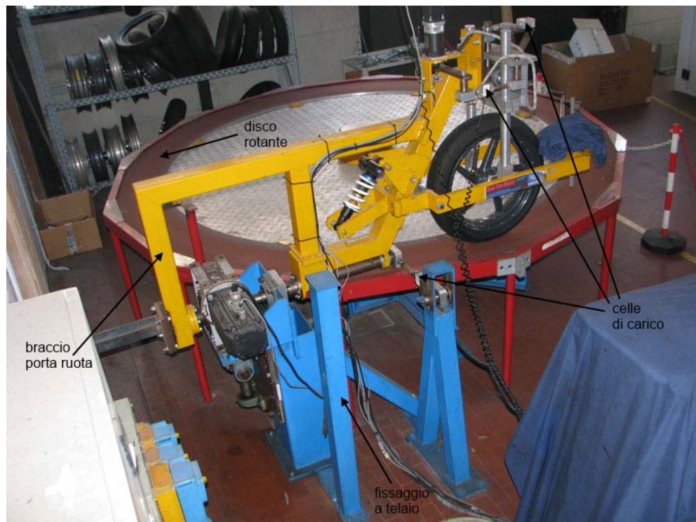
Figura 1.11: Macchina di misura MotoTireMeter
