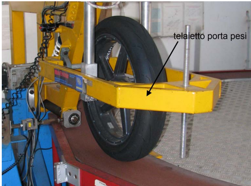
Figura 1.16: Telaioetto porta pesi, per l'applicazione del carico verticale sullo pneumatico
