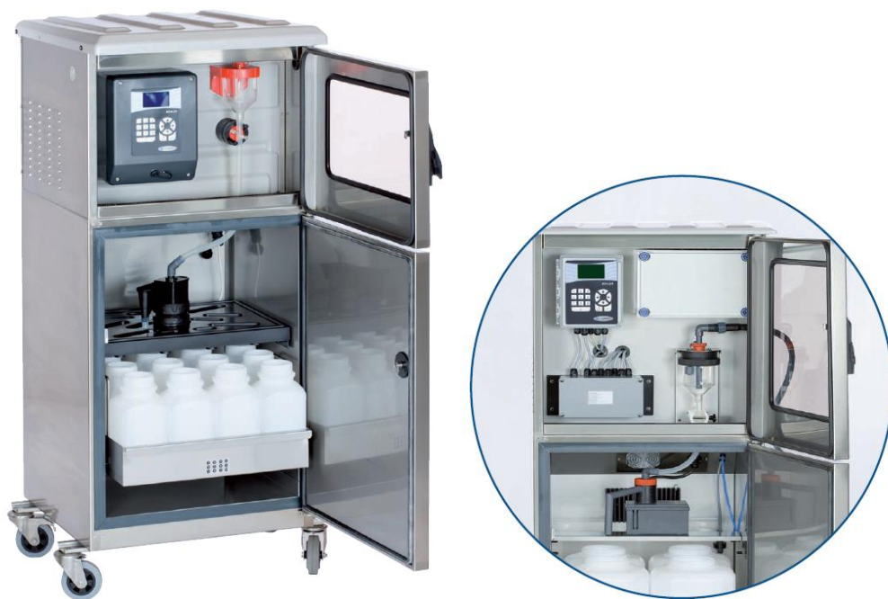
Figura 14: campionatore automatico costituito da cella frigorifera, bottiglie di conservazione dei campioni, sistema automatizzato di prelievo dei campioni (parte alta dell'armadio)
