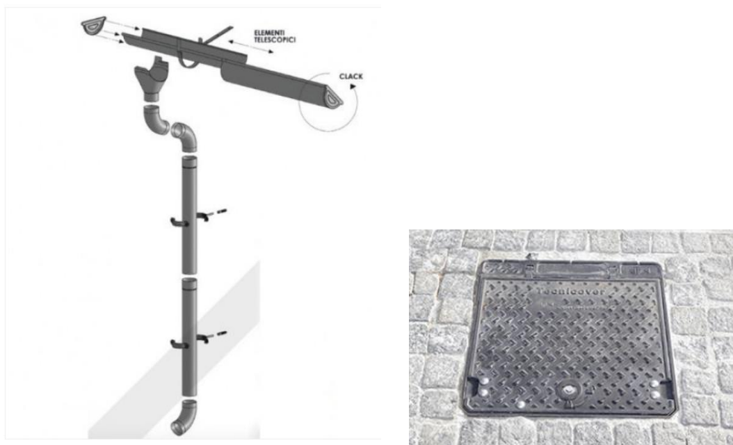
Figura 5: grondaia, pluviale e chiusino
