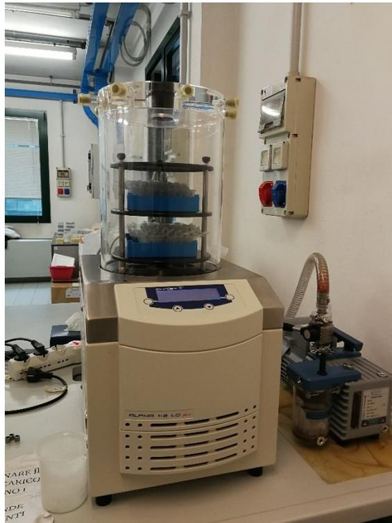
Figura 1 Liofilizzatore acceso e in azione, permette di essiccare i prodotti acquosi portandoli ad una temperatura di  $-55^{\circ}\text{C}$
