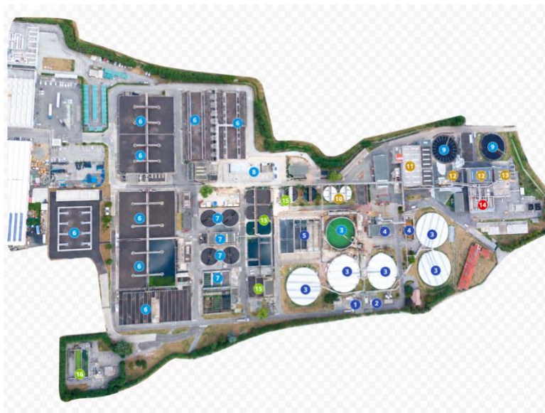
Figura 2.1.2: vista dall'alto depuratore di Arzignano con numeri in blu per la linea industriale (Acque del Chiampo, 2026)
