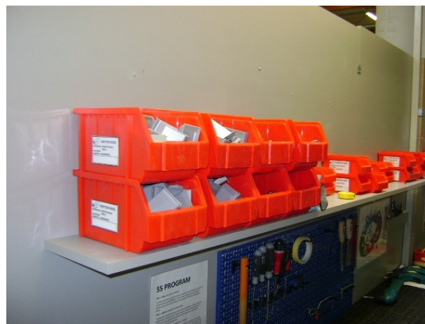
Figura 3.7 – Contenitori per l’utilizzo del kanban “vuoto per pieno” in area produzione di Idea (IdeaGroup, 2022)
