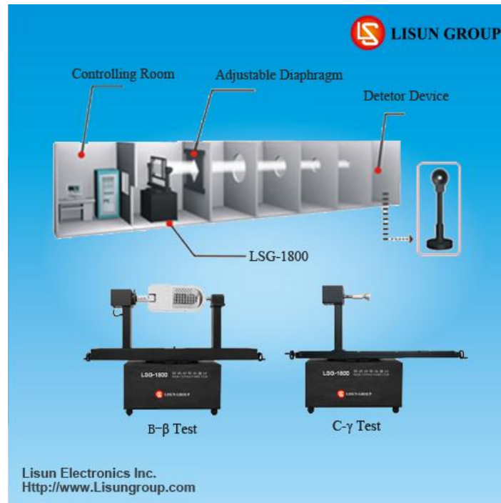
Fig.6.9 - Posizionamento goniofotometro e struttura laboratorio
