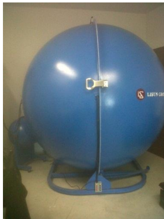
Fig.6.6 - Laboratorio: sfera di Ulbricht; diametro 2m
