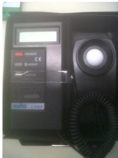
Fig.6.14 - Immagine luxmetro LX421 ASITA
