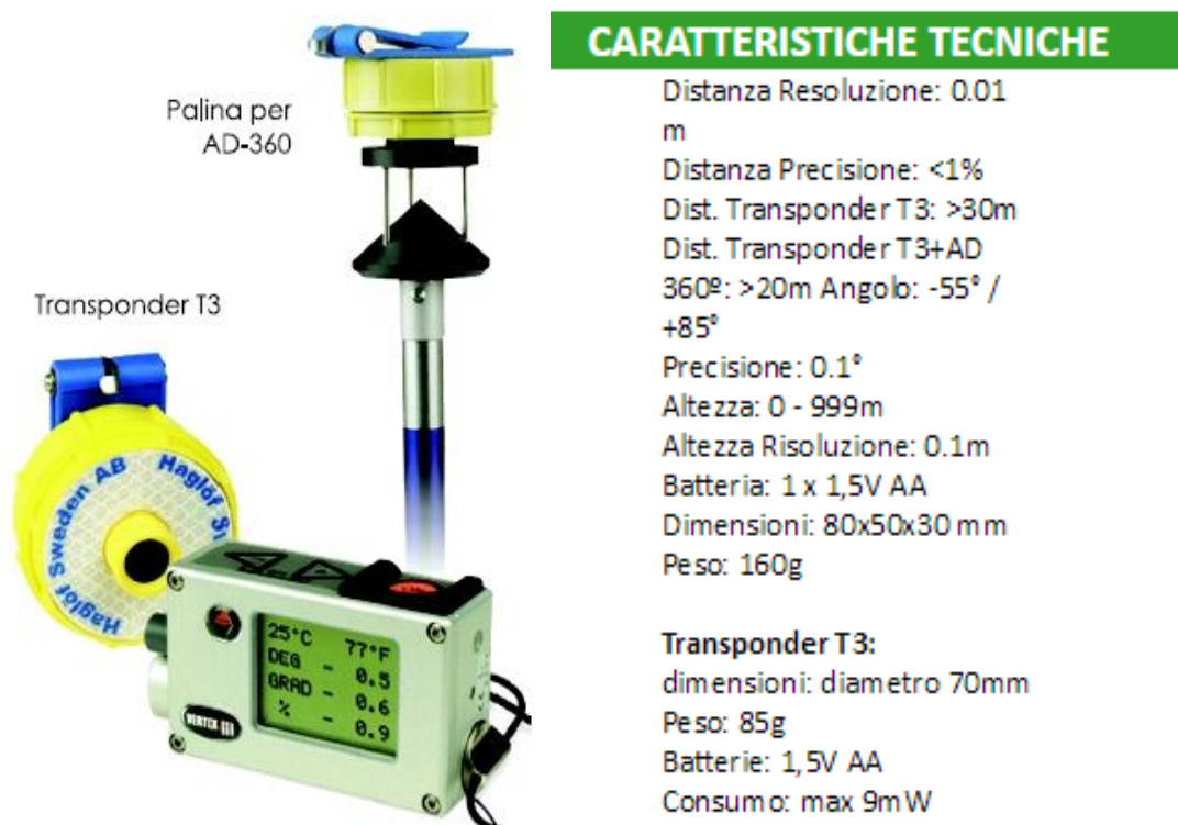
Figura 10. Scheda tecnica dell'ipsometro elettronico Vertex IV BT (da: https://www.tecnomarket.it/tecnis/usati/i/ipsometro-vertex.htm )
