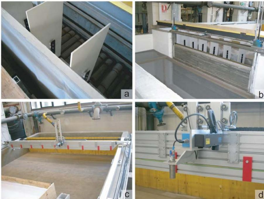
Figure 9: Componenti principali della lagunetta nell'apparato sperimentale: a) Rotoli di rete metallica distribuiti al di sopra del tubo di alimentazione, setti verticali in pvc e rete metallica verticale. b) Paratoia con bordo affilato in acciaio. c) Carroponte in alluminio su cui sono montati il laser e la sonda ad ultrasuoni. d) Accoppiamento laser-sonar.
