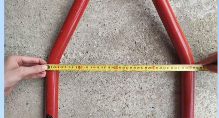
Scelto come soggetto un cavalletto posteriore dell'azienda Bike-Lift si è proceduto alla raccolta delle misure attraverso due strumenti principalmente: una **cordella metrica** e un **calibro ventesimale**.
