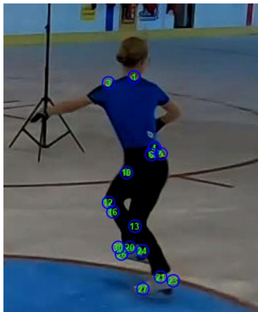
Figura 23: Esempio di collocamento dei punti anatomici durante la fase di tracking, grazie alla presenza dei marker
