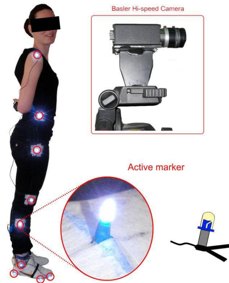
Figura 3: Soggetto con marcatori attivi installati (a sinistra), telecamera industriale veloce Basler 602fc (in alto) e marcatore attivo ingrandito (in basso), https://www.researchgate.net/
