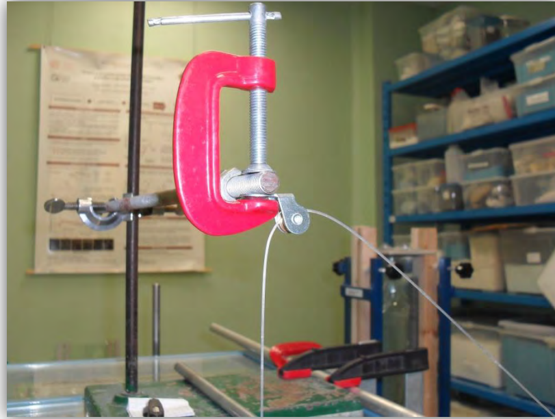
Figura 2.14: Sistema di morsetti e carrucole dell'apparato sperimentale
