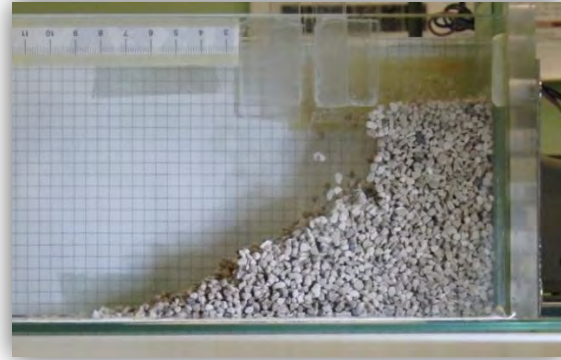
Figura 3.27: CC 2000/2830 \mu\text{m} con 2,5% di acqua
