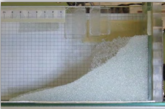
Figura 3.28: palline di vetro 750/1000 \mu\text{m} con 0,2% di acqua
