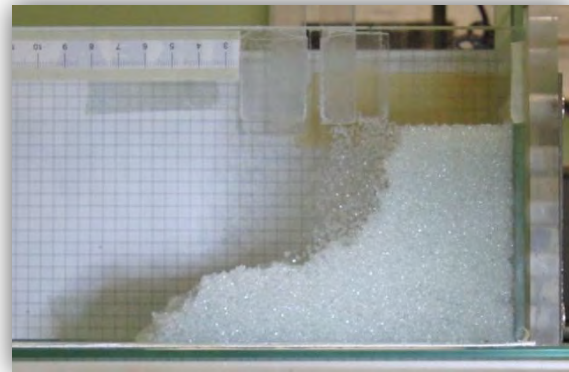
Figura 3.29: palline di vetro 750/1000 \mu\text{m} con 1% di acqua
