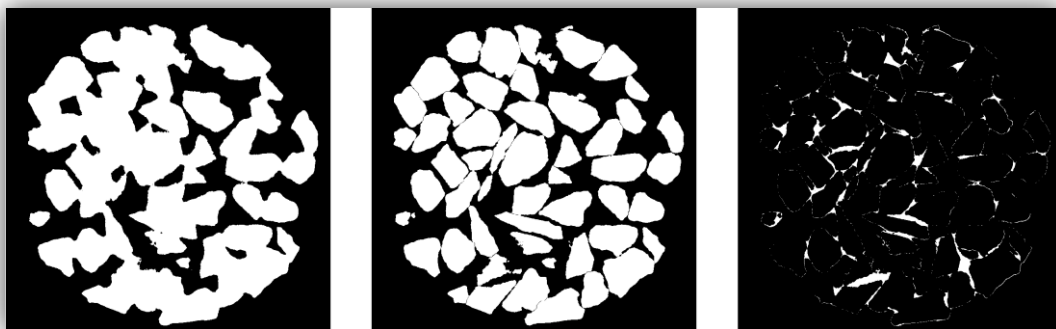
Figura 2.10: Processo per l'identificazione liquido : 1) immagine di esempio a umido; 2) campione secco ; 3 ) immagine ottenuta per sottrazione contenente il contributo che contiene solo acqua
