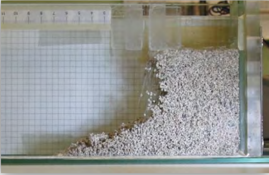
Figura 3.26: CC 1180/1410 \mu\text{m} con 2,5% di acqua
