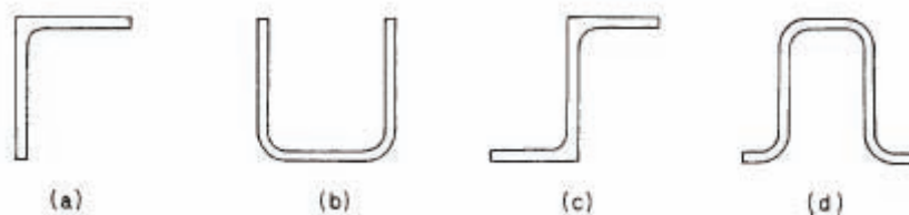
Fig. 2.4 Esempi di possibili sezioni per travi in parete sottile: a) Sezione ad angolo retto; b) Sezione a U; c) Sezione a canale ( channel ) d) sezione a "top hat" [39]
