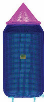
Fig. 5.12 Nodi della mesh ai quali è stato associato un offset
