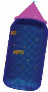
Fig. 5.14 Localizzazione dei difetti del materiale inseriti nel modello FEM
