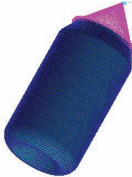
Fig. 5.8 Mesh lattina ed elemento MPC
