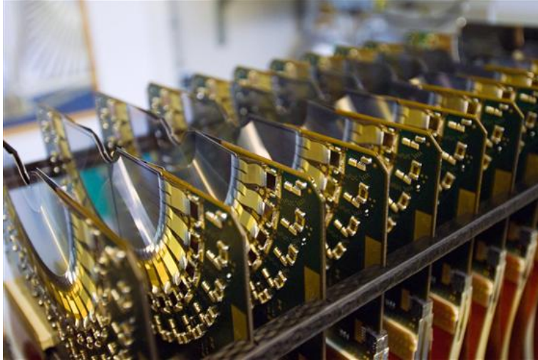
Figura 2.2.3: Foto di alcuni sensori costituenti del rivelatore VELO. Si possono notare le coppie di sensori R e \phi affiancati, distanziati di qualche millimetro (fonte: CERN).
