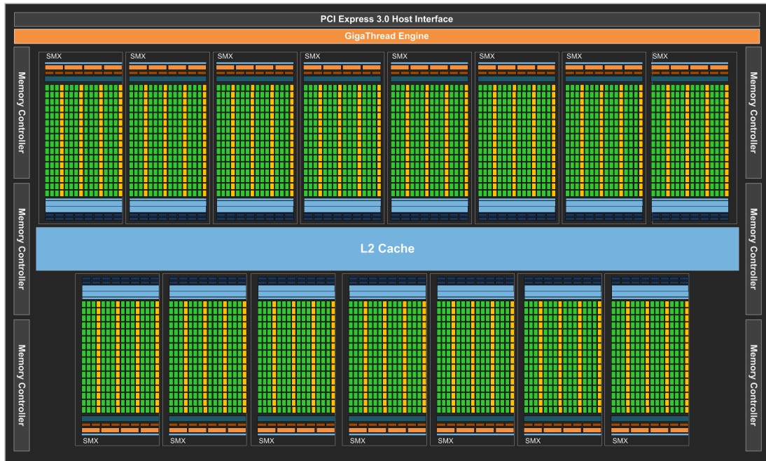
Figura 6.1.2: Struttura del processore grafico GK-110 (architettura Kepler2). Nella GTX Titan uno dei 15 SMX è disabilitato. In verde sono indicati i core single precision (float), in giallo quelli double precision (double).
