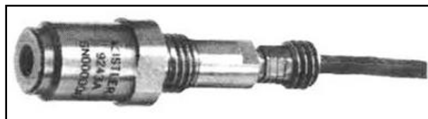
figura 3.96 – Cella di carico per la forza normale: viene impiegata sia per misure di compressione che trazione.
