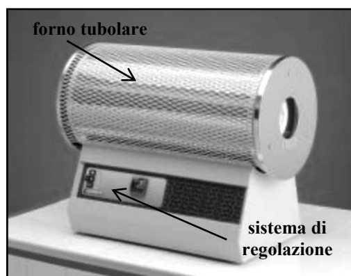
figura 3.56 – Forno Carbolite® con regolazione PID ad una sola zona
