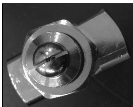
figura 3.30 – Particolare della sezione d'uscita rettangolare dell'ugello Vortex®
