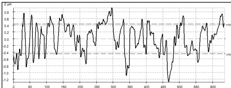
figura 3.108 – Profilo della superficie dello stampo su una retta parallela a X
