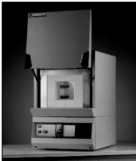
figura 3.58 – Forno a muffola Carbolite® (temperatura massima = 1600 °C)
