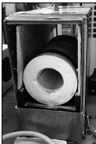
figura 3.53 – Forno tubolare in fibra di ceramica prodotto da Watlow®
