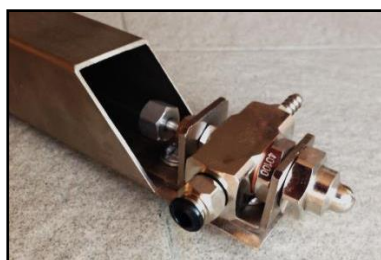
figura 3.83 – Sistema di fissaggio dell'ugello al profilo di guida
