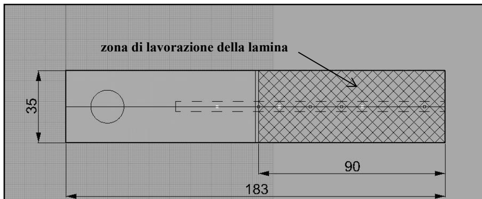
figura A.7 – Zona di lavorazione della lamina: 90 \times 35 \text{ mm}
