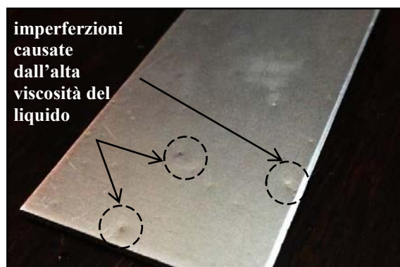
figura 4.9 – BonderiteL-FM747 depositato sulla lamina, con rullo
