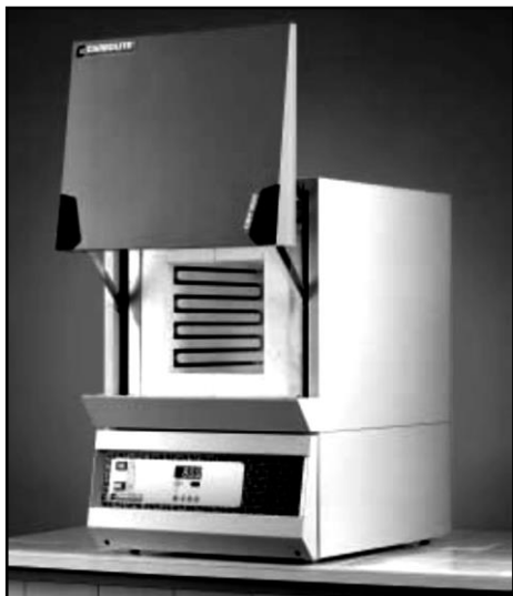
figura 3.57 – Forno a muffola Carbolite® (temperatura massima = 1200 °C)
