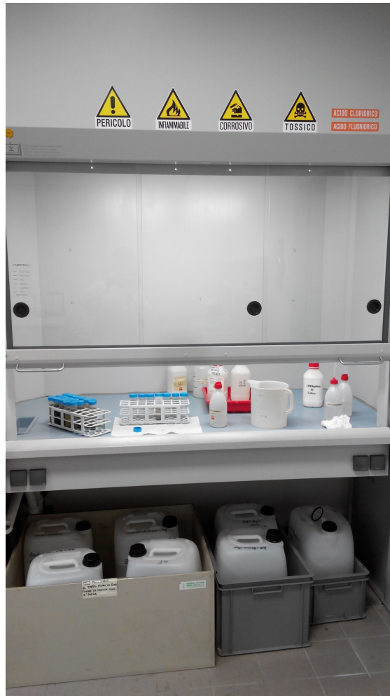
Fig.1.2: Cappa aspirante per l'operazione di acidificazione dei campioni
