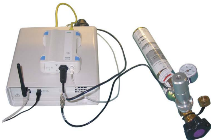
Figura 2.6: Configurazione per la Calibrazione Analizzatori Gas [11]
