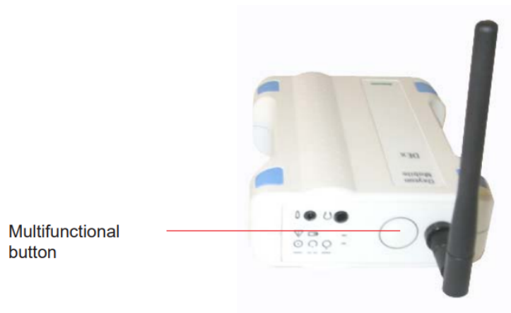
Figura 2.2: Tasto multifunzionale dell'unità DEx da premere per l'accensione [11]
