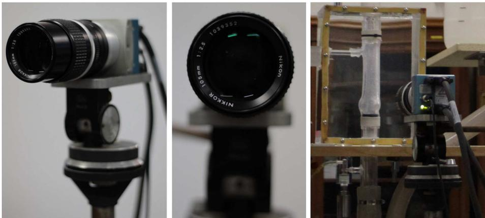
**Figura 4.24.** Da sinistra: visione di 3/4 e frontale della videocamera, a destra in funzione durante la registrazione.
