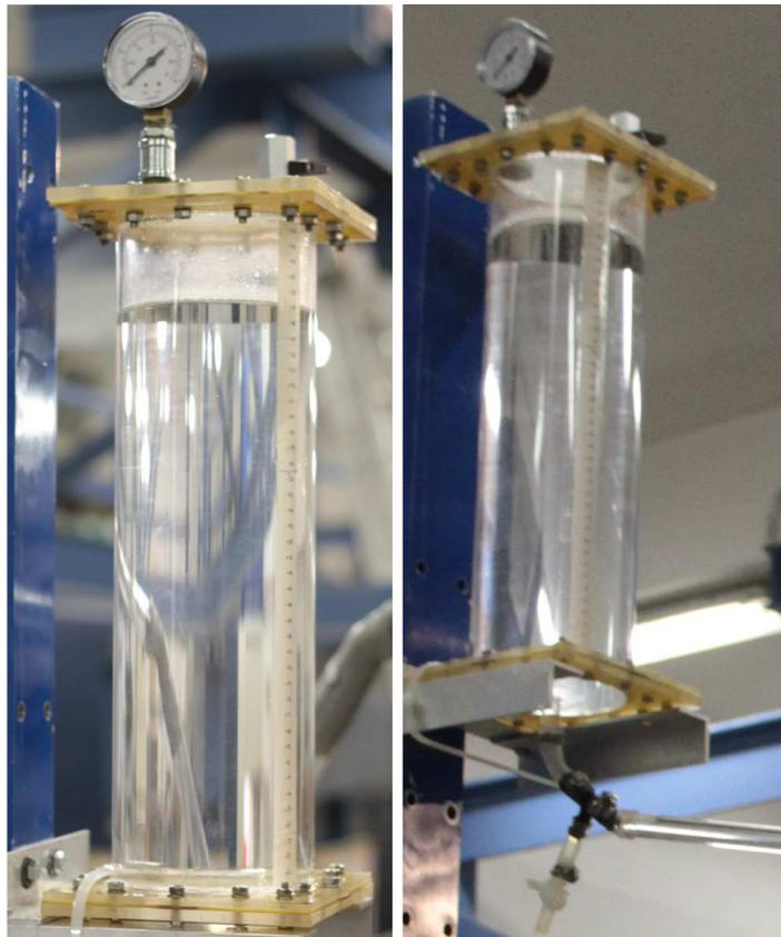
**Figura 4.17.** Viste diverse della camera di compliance, si noti il rubinetto di sfiato posto sul piattello superiore, la striscia millimetrata, ed il collegamento sul fondo al circuito idraulico.
