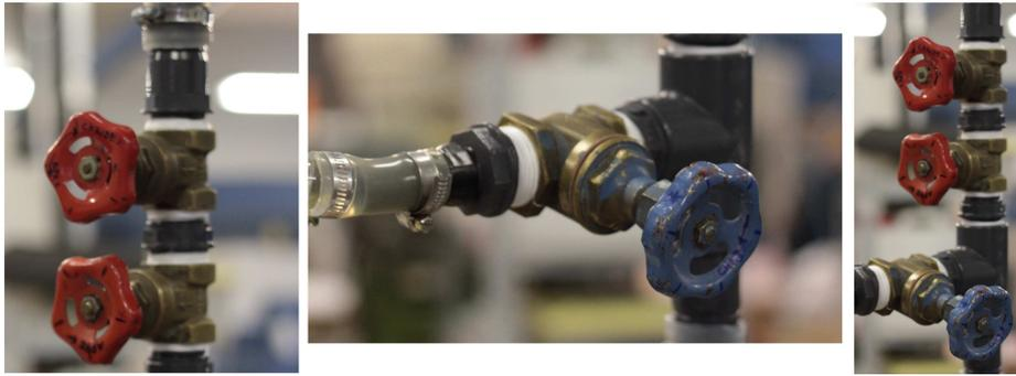
**Figura 4.16.** A sinistra: i due rubinetti in serie con cremagliera rossa sono gli elementi che simulano la resistenza periferica fisiologica. Al centro è rappresentato il rubinetto che regola il flusso da e verso la camera di compliance. A destra la porzione di circuito che comprende tutte e tre le valvole.
