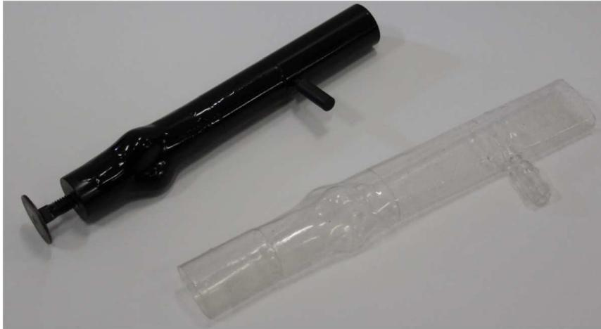
Figura 4.13. Stampo in PVC e modello in silicone dell'aorta.
