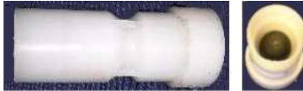
**Figura 4.10.** Valvola mitralica, realizzata con valvola di non ritorno del tipo a molla, posta all'uscita della camera ventricolare nel ramo di collegamento al serbatoio di mandata.
