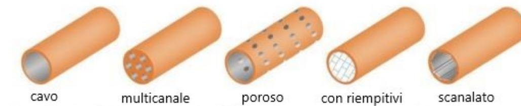
Figura 10: design delle neuroguide, da sinistra: cavo, multicanale, poroso, con riempitivi in fibra o hydrogeel, scanalato
