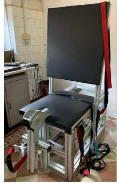
Figura 3: Dinamometro isometrico custom made ed annessa cella di carico Kraftaufnehmer Type S9 utilizzati durante la ricerca.
