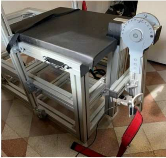
Figura 3: Dinamometro isometrico custom made ed annessa cella di carico Kraftaufnehmer Type S9 utilizzati durante la ricerca.
