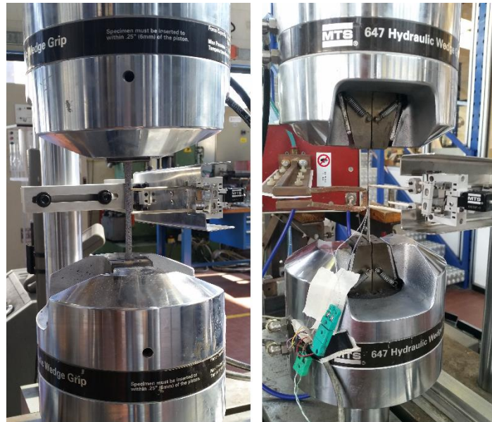
Fig. 4.15: prove di carico e scarico con estensometro a freddo e a caldo.
