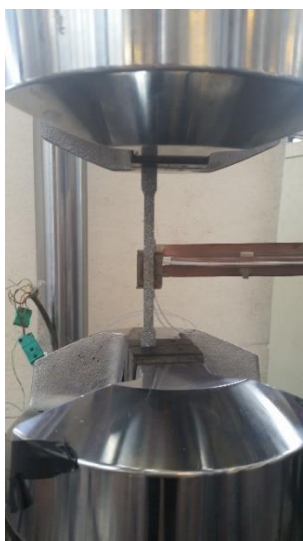
Fig. 4.9: Testa di riscaldamento posta vicino al campione durante la prova per attuare il riscaldamento localizzato e dettaglio della testa di riscaldamento.
