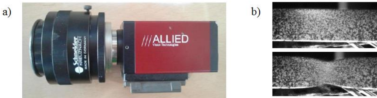
Fig. 4.11: a) telecamera ad alta frequenza adottata per monitorare la deformazione durante la prova di trazione; b) Esempio della distribuzione stocastica di punti sulla superficie del campione in due diversi momenti della prova a trazione.
