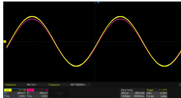
Relazione tensioni d'ingresso e uscita:
