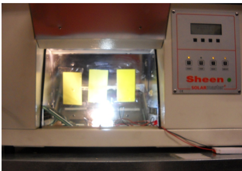
Figura 8.11 La camera UV per la prova di stress sotto raggi UV
