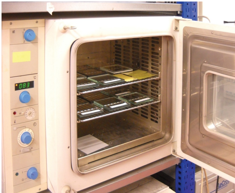
Figura 8.10 Forno per le prove di stress in temperatura @85°C
