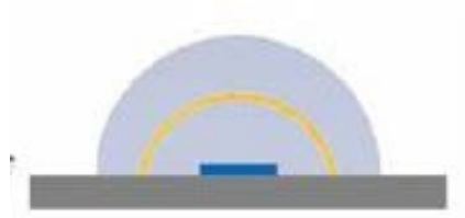
Figura 5.19 Remote coating disposto su di una superficie convessa
