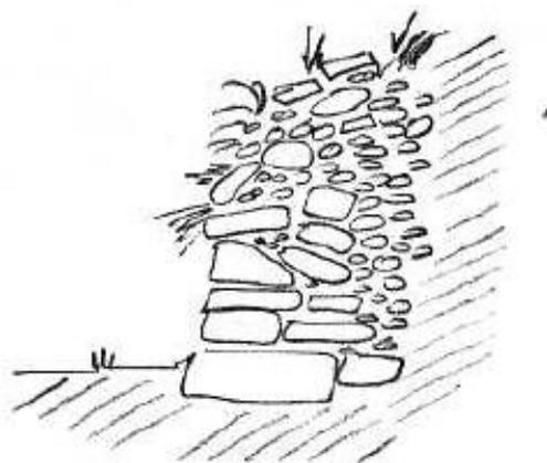
Figura 5: Collasso della parte superiore del muro, dovuta alla scarsa manutenzione del coronamento e alla vegetazione tra le pietre (Fonte: Sangiorgi 2007)
