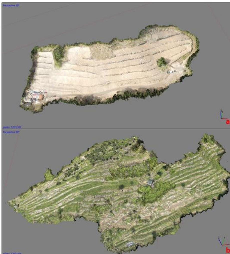
Figura 26: Nuvole dense di punti del rilievo di Malegno (a) e di Darfo Boario Terme (b) "ripulite" dalla vegetazione esterna
