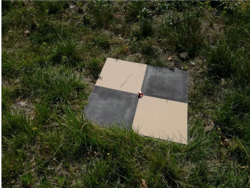
*Figura 19: Pannello di compensato utilizzato per il rilievo*
