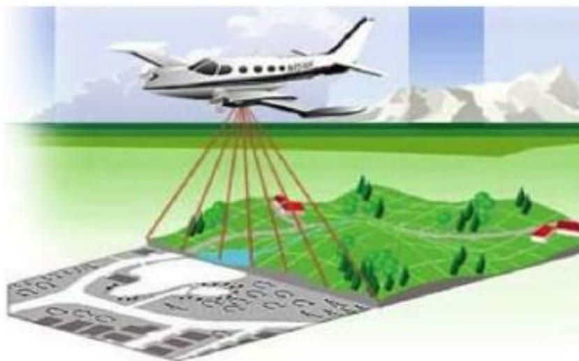
Figura 11: Sistema LIDAR aereo (Fonte: Abed e Mcgough 2017)
