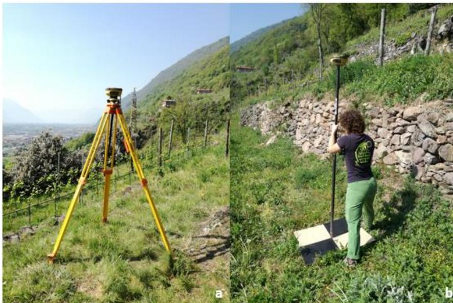
*Figura 20: Stazione totale GPS utilizzata per il rilievo (a) e rilevazione delle coordinate al centro dei targets (b)*
