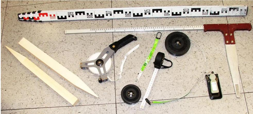
**Figura 5.22 – Strumenti di misura utilizzati nella fase di rilievo in campo; Da sinistra: picchetti segnalatori, cordelle metriche, clisimetro, cavalletto forestale, asta telescopica.**
