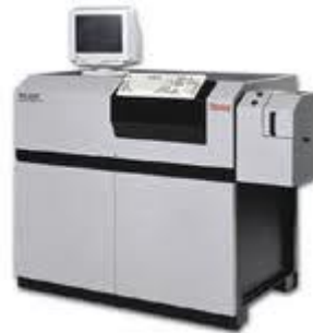
Figura 2.1: Quantometro, l’unità dove viene posto il campione è quella esterna di destra.
