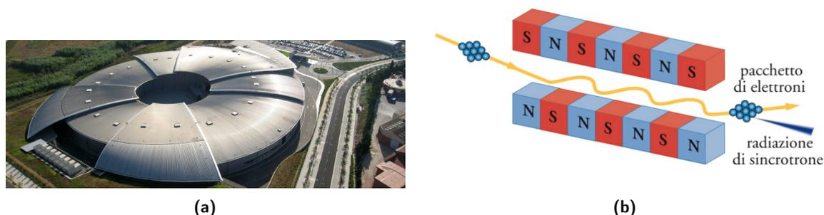
**Figura 2.14:** (a) La struttura esterna del Sincrotrone ALBA; (b) Onduttore: struttura con campo magnetico periodico creato da poli alternati.
