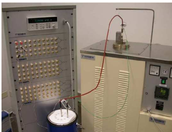
Figura 2.2.7: Forno elettrico verticale con TC campione e vaso di Dewar.
