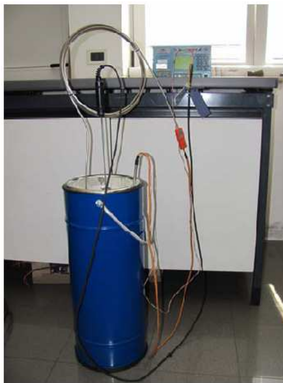
Figura 2.1.2: vaso Dewar con termocoppia di riferimento e del campione.
