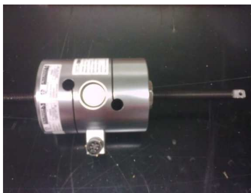
Figura 3.2.1: cella di carico utilizzata per la taratura.
