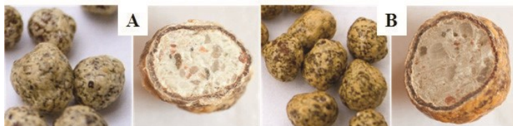
Figura 8: A- Granuli di fertilizzante ricoperti da solo i primi due strati; B- granuli di fertilizzante ricoperti da tutti e tre gli strati. [31]
