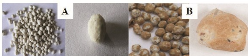
Figura 6: A – Granuli del fertilizzante commerciale multicomponente; B - granuli del fertilizzante ricoperti dallo strato di chitosano. [31]
