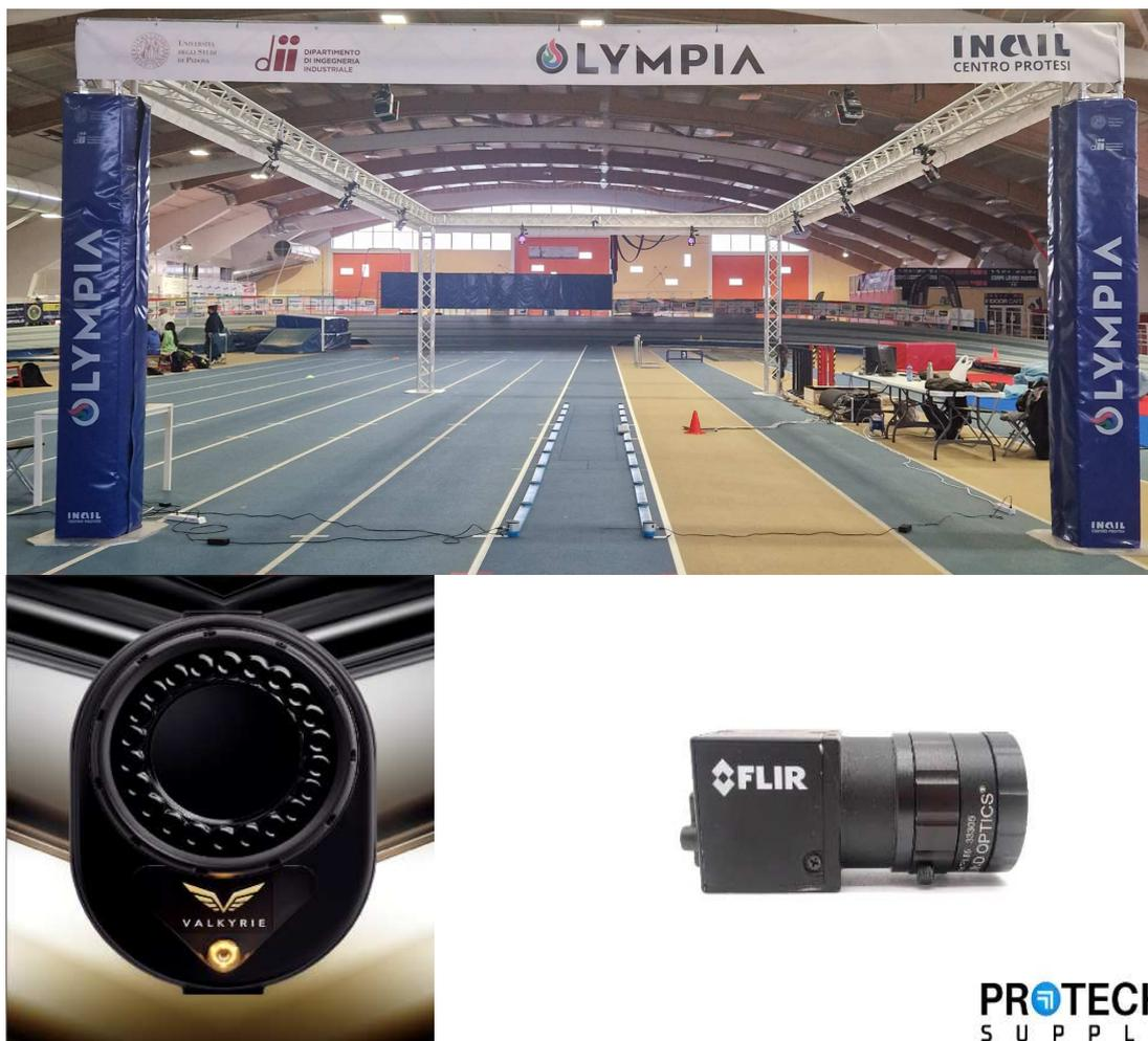
Figura 1. Visione d'insieme del portale con le telecamere ad esso fissate. In basso dettaglio di una delle camere optoelettroniche (sulla sinistra) e di una delle videocamere digitali (sulla destra).
