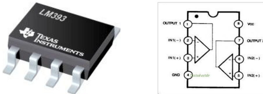
Figura 2.19 – Comparatore LM393 e piedinatura integrato
