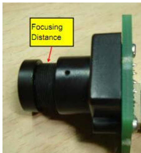
Figura 2.10 - Lente regolabile da 7.9 mm
