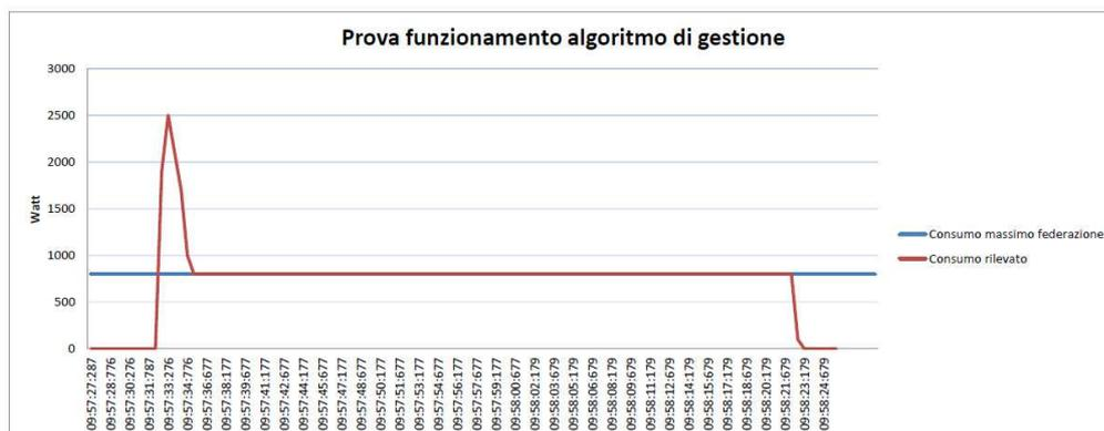
Figura 7.3: Test dell'algoritmo distribuito di gestione della potenza, si nota come dopo un transitorio la comunicazione con le adiacenze permetta di mantenere i consumi sotto controllo
