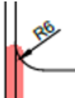
Figura 1.22: raccordo spallamento F-F
