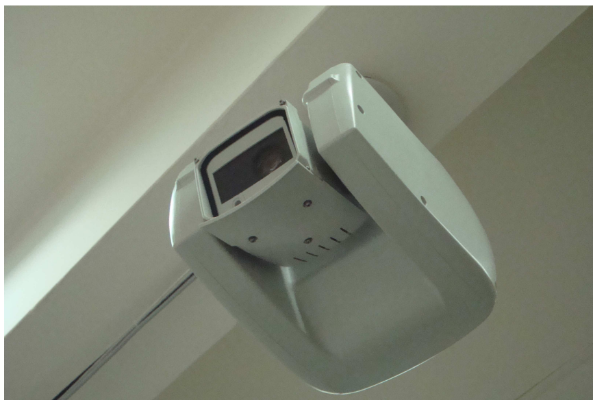
Figura 2.1: Il brandeggio Ulisse Compact della ditta Videotec S.p.A. installato sul soffitto del laboratorio.
