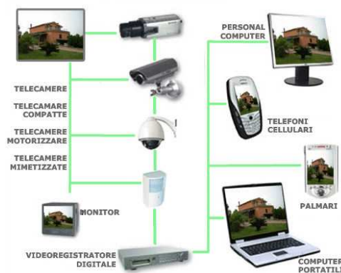
Figura 1.2: Esempi di strumentazione per TVCC collegati tra loro.
