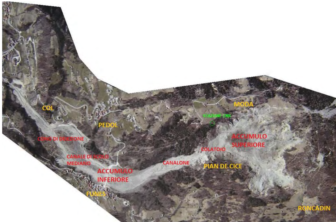
Figura 1.6 - Visione satellitare della frana del Tessina in cui sono indicate le diverse aree e la postazione di monitoraggio (G. Dal Farra, Genio Civile di Belluno - indicazioni sulla foto da me riportate)
