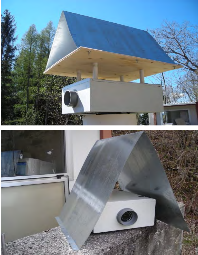
Figura 2.7 - Protezioni per le due fotocamere (foto da me realizzata)
