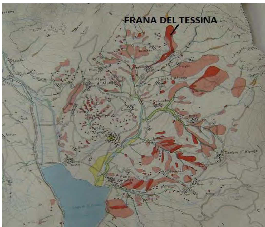
Figura 1.2 - Cartina e relativa legenda dei movimenti franosi in Alpago (G. Dal Farra, Genio Civile di Belluno)
