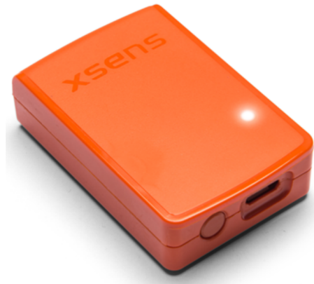
Figura 6: Sensore inerziale MTw Awinda di XSens per la raccolta dei dati sulla posa della persona. Tra le informazioni raccolte sono compresi gli angoli articolari, le posizioni assolute di diversi punti del corpo e il centro di massa.
