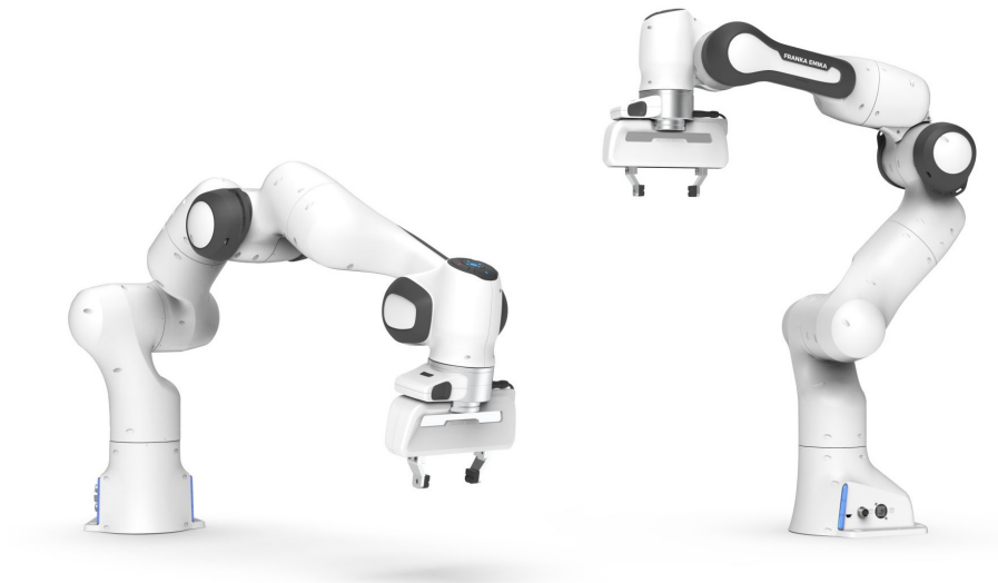
Figura 10: Robot Franka Emika Panda utilizzato per la collaborazione con l'operatore nella raccolta del dataset.
