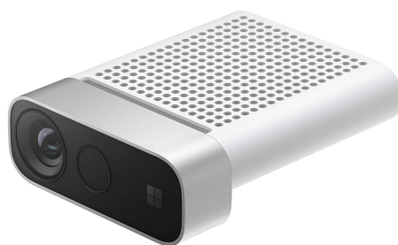
Figura 8: Una delle telecamere Azure Kinect utilizzate per registrare le azioni nel dataset. Ognuna dispone di un sensore di profondità, una videocamera a colori, un accelerometro, un giroscopio e un array di microfoni.
