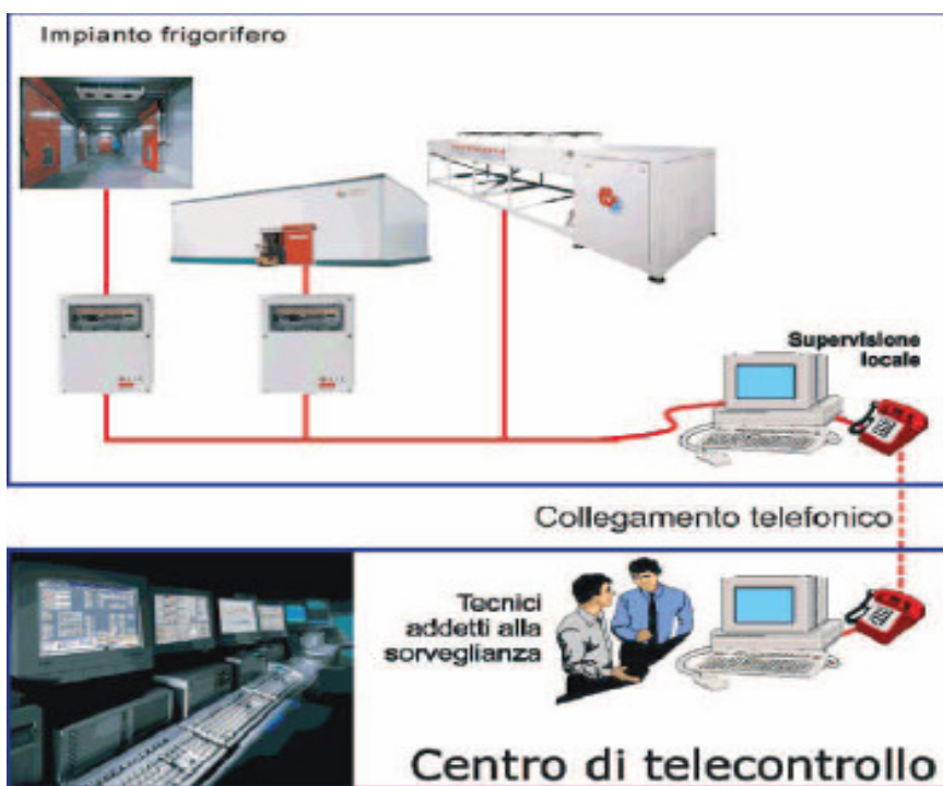
Fig. 3.1.1 Controllo impianto frigorifero
