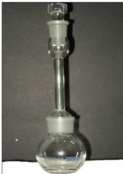
**Fig. 3.5:** *Picnometro usato per la misura di densità intrinseca*
