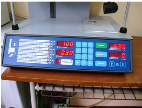
Figura 6.15. Dati impostati: tempo sosta [min] opaco con vuoto
