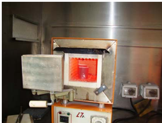
Figura 5.6. Preriscaldamento del cilindro in forno
