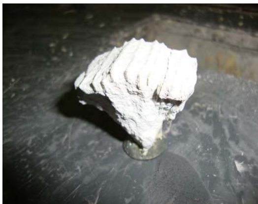
Figura 5.15. La fusione estratta dal rivestimento
