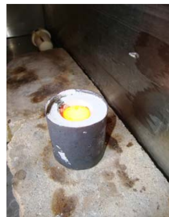
Figura 5.14. Cilindro con la lega colata
