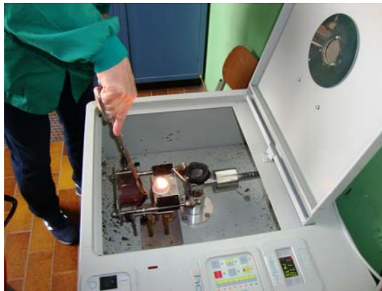
Figura 5.12. Inserimento del cilindro prima della colata della lega per centrifugazione notare la lega fusa nel crogiolo
