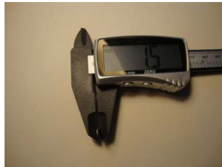
Figura 6.19. Spessore totale provino
