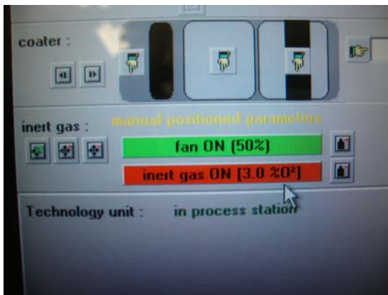
Figura 5.35. Gas inerte bloccato (%O 2 > 1,9%)
