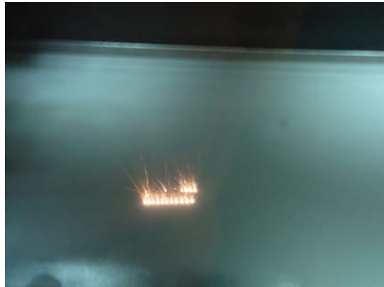
Figura 5.30. Laser in azione sullo strato di polvere metallica – vista ravvicinata
