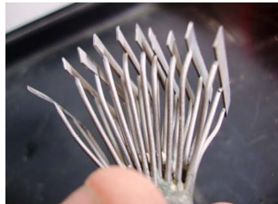
Figura 5.18. I provini dopo la sabbiatura di eliminazione del rivestimento
