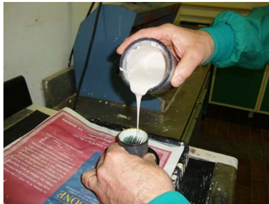
Figura 5.5. Colata del rivestimento
