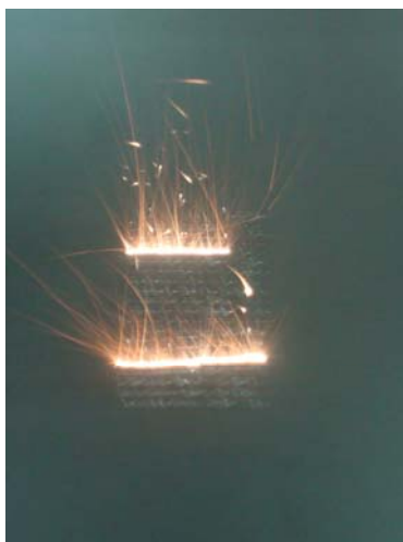
Figura 5.37. Laser in azione – visibili i bordi dei provini
