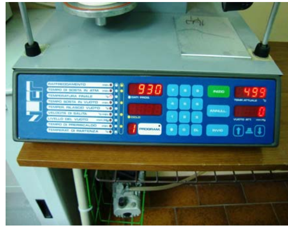
Figura 6.14. Dati impostati: T iniziale e finale cottura opaco
