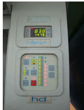
Figura 5.11. – display della fonditrice con la temperatura raggiunta al momento dello scatto (sopra) e quella da ottenere per la colata della lega (sotto – 1475 °C)
