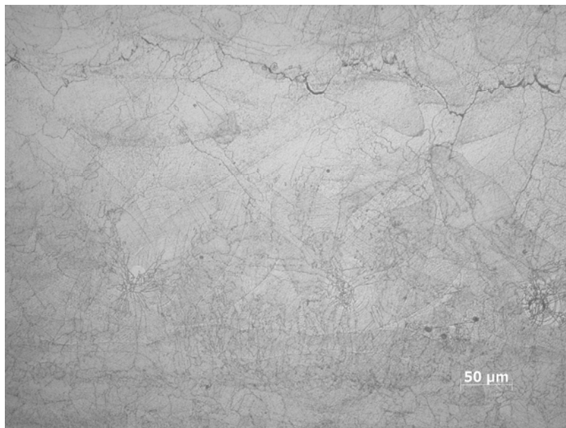
Immagine n. 4: Grana cristallina di un provino SLM ceramizzato dopo delaminazione (200X)
