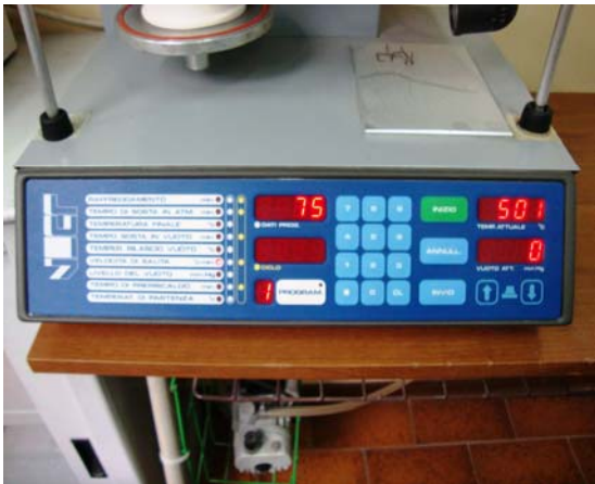
Figura 6.13. Dati impostati: velocità di salita T cottura opaco
