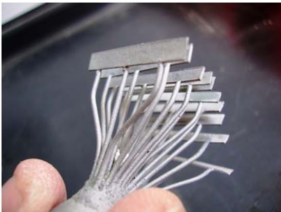
Figura 5.17. I provini dopo la sabbiatura di eliminazione del rivestimento
