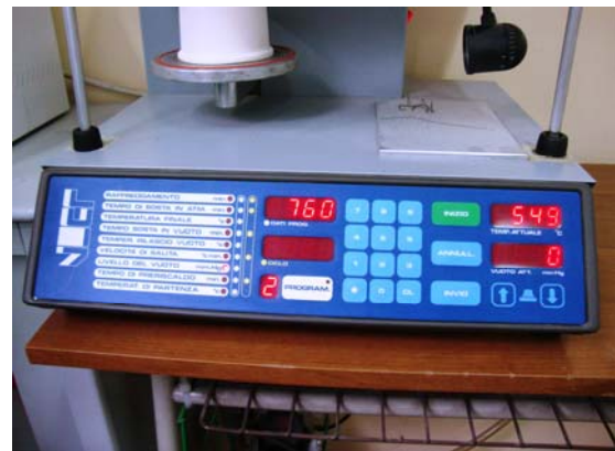
Figura 6.16. Dati impostati: T cottura dentina e valore del sotto vuoto [mm Hg]
