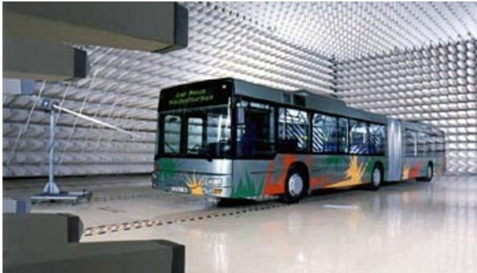
Fig. 4.3.2: Camera anecoica per l'effettuazione delle prove di EMC
