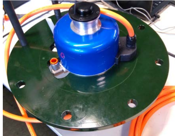
Figura 3.38: Motore montato sulla flangia per test al banco
