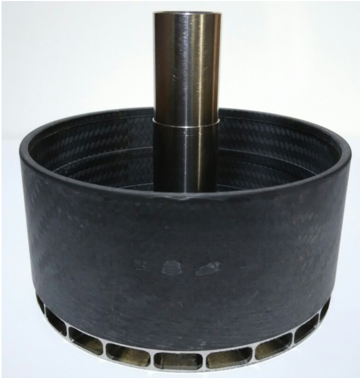
Figura 3.21: Rotore in titanio con anello in CFRP
