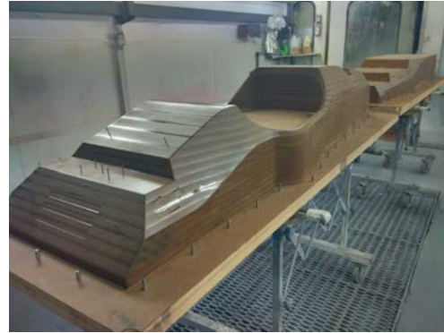
Figura 4.7: Rivestimento con resina epossidica dei modelli fresati
