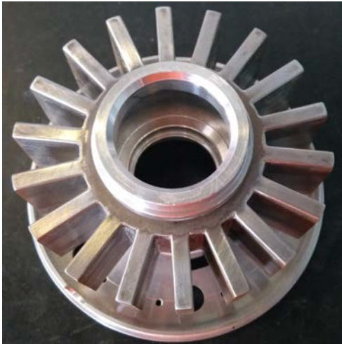
Figura 3.27: Statore a cave aperte con relativo supporto in alluminio
