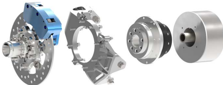
Figura 3.3: Esploso del gruppo ruota. Da sinistra: mozzo con disco freno e relativa pinza, portamozzo, riduttore, motore
