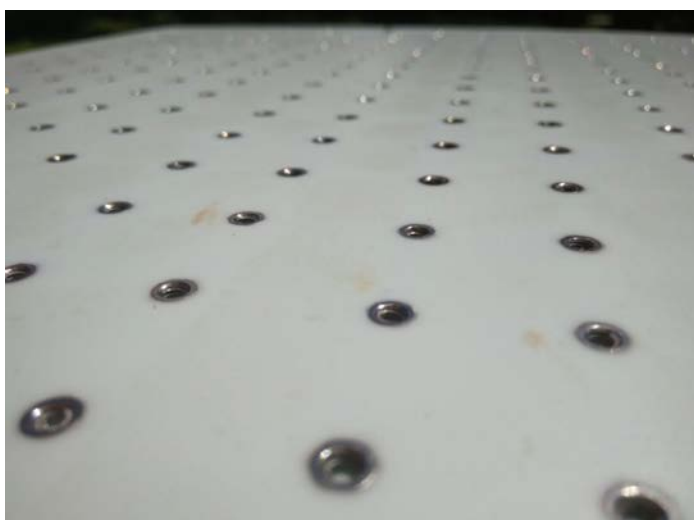
Figura 3.47: Piastra con dadi laminati pronta per essere tagliata nelle varie piastre di supporto
