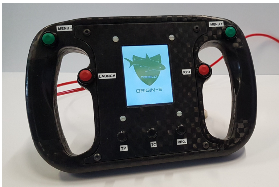
Figura 4.26: Volante con display e datalogger integrato
