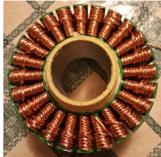
Figura 3.19: Avvolgimenti in filo litz realizzati manualmente
