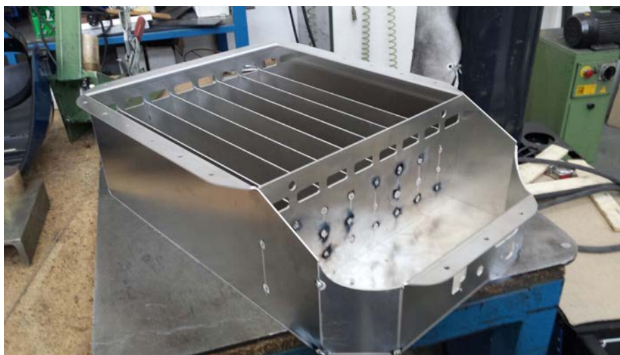
Figura 3.45: Scatola dell'accumulatore in lamiera di alluminio saldata
