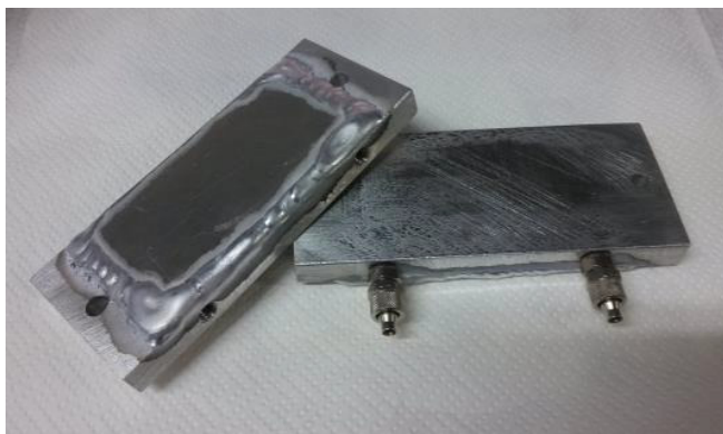
Figura 3.63: Blocchi di raffreddamento in alluminio
