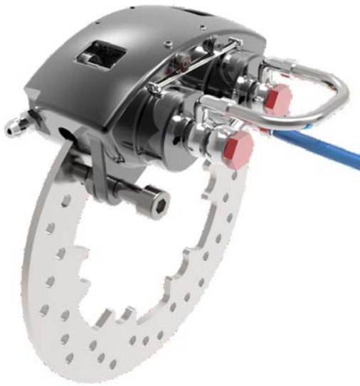
Figura 4.24: Pinza progettata e relativo disco freno
