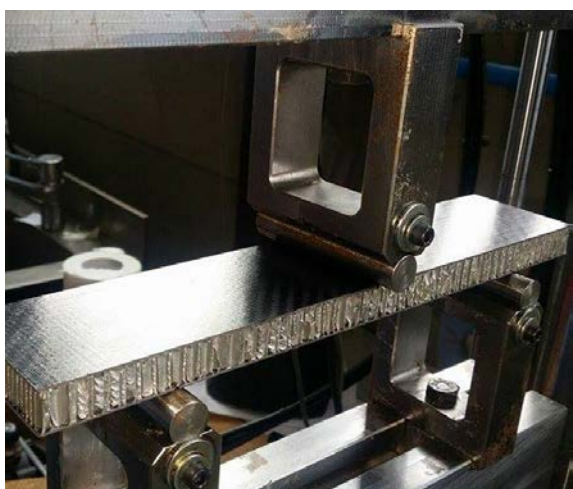
Figura 4.4: Pannello con struttura a sandwich durante un test di flessione a 3 punti
