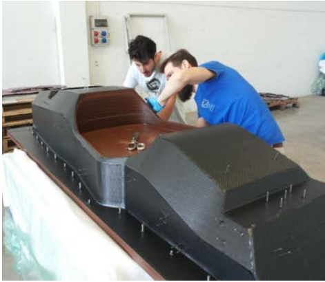
Figura 4.8: Stesura del tooling prepreg sui modelli rivestiti in resina
