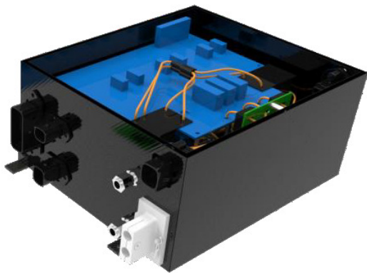
Figura 3.61: Scatola in materiale composito contenente coppia di inverter
