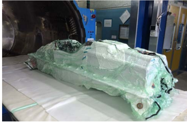
Figura 4.9: Inserimento in autoclave dopo l'applicazione del sacco a vuoto
