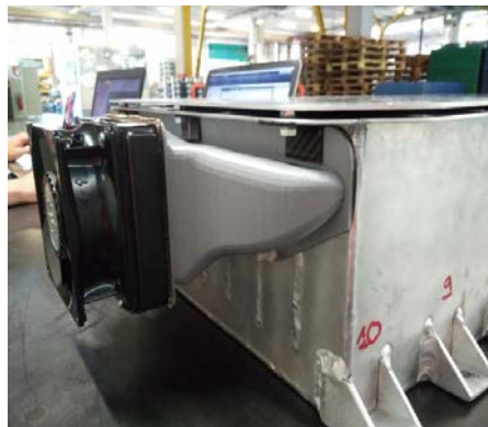
Figura 3.64: Integrazione del radiatore
