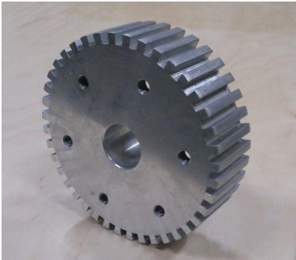
Figura 3.29: Dima in alluminio per l'incollaggio di precisione dei magneti
