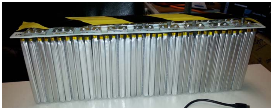
Figura 3.46: Modulo assemblato con busbars fissate sulla relativa piastra di supporto isolante
