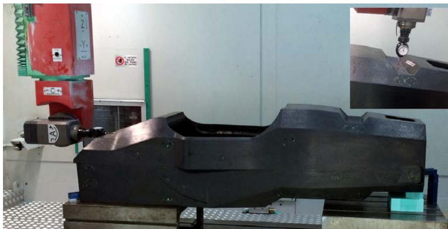
Figura 4.12: Monoscocca in fase di misura su fresa a 5 assi
