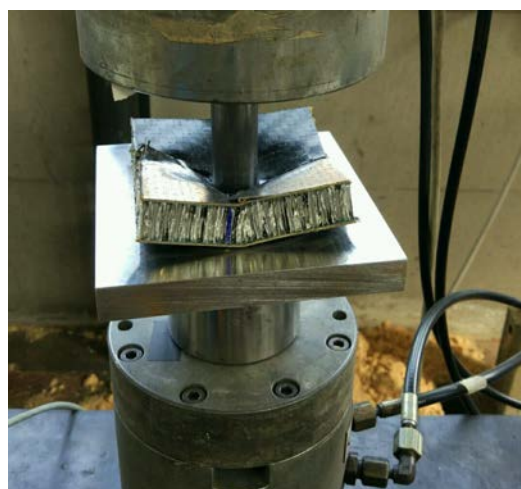
Figura 4.5: Provino con struttura a sandwich sottoposto a test a penetrazione
