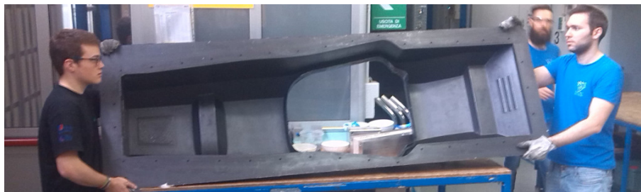
Figura 4.10: Estrazione degli stampi dal modello
