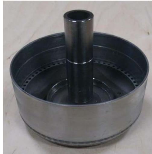
Figura 3.30: Rotore mono-blocco in titanio
