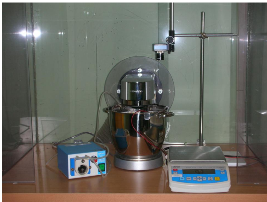
Figura 3.3 Attrezzatura completa per la parte sperimentale. Al centro si ha il mixer, a sinistra la pompa peristaltica, a destra la bilancia ed il sensore tenuto sospeso sopra il mixer.
