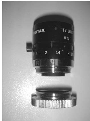
Figura 4.9 Obiettivo da 12 mm utilizzato per le prove, con distanziale da 5 mm.
