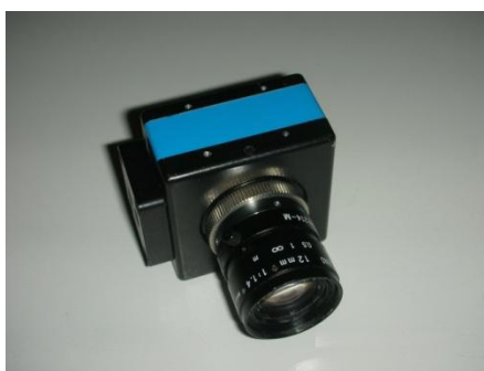
Figura 3.4 Sensore Bayer USB con obiettivo Pentax da 12 mm.
