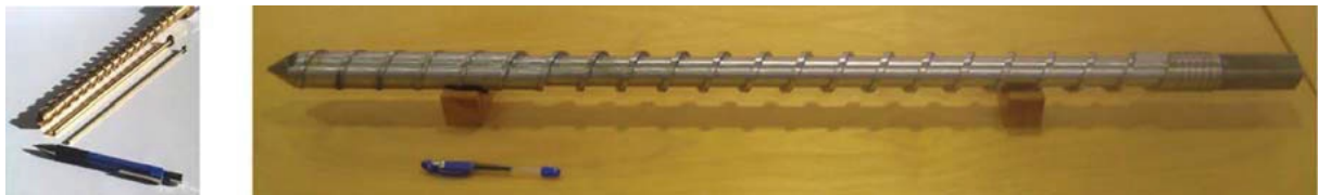
Figura 2: Confronto tra la vite ed il pistone di iniezione del \mu IM (sinistra) e la vite dello stampaggio ad iniezione.
