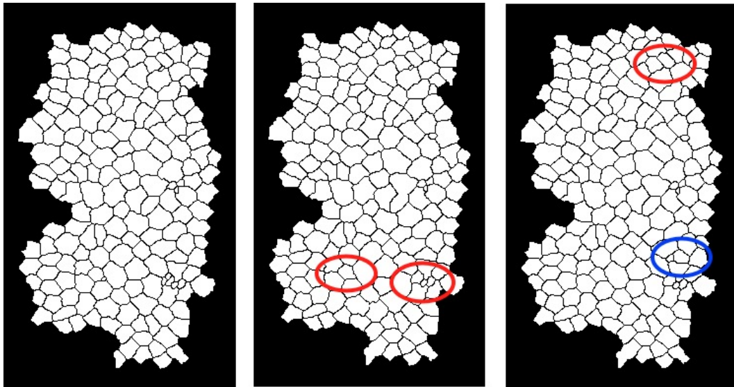
Figura 3.16: Processo iterativo di fusione e divisione: in rosso sono evidenziate fusioni di cellule piccole, in blu divisioni di cellule grandi.
