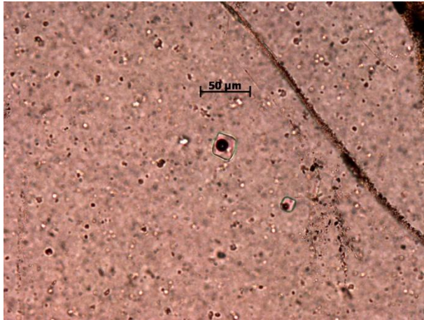
Figura 10: Melt inclusions all'interno di un cristallo di quarzo appartenente all'ignimbrite riolitica della formazione di Ora . Vicino alle due inclusioni si nota una frattura riempita. (Szione sottile IF - 20, ingrandimento 20x).
